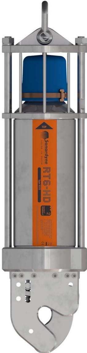
**El Release Transponder 6 Heavy Duty (RT 6-HD) Tipo 8322 es un liberador acústico resistente y confiable con un Límite de Carga de Trabajo (WLL) de 2.500 kg, diseñado para su despliegue en hasta 7.000 m de agua y es totalmente compatible con los transceptores 6G® y los sistemas USBL de Sonardyne.**
